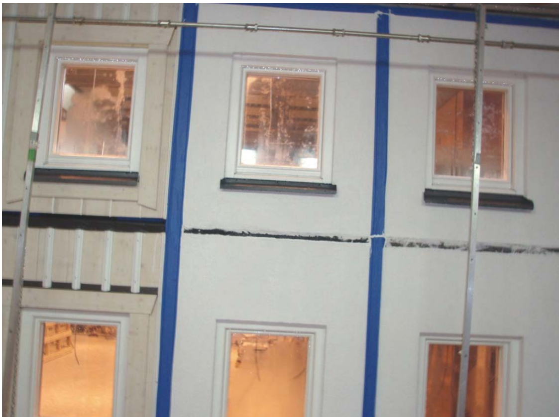
Bild 1c: Utsida av fasad monterad i regnkammare, färdig för test.
