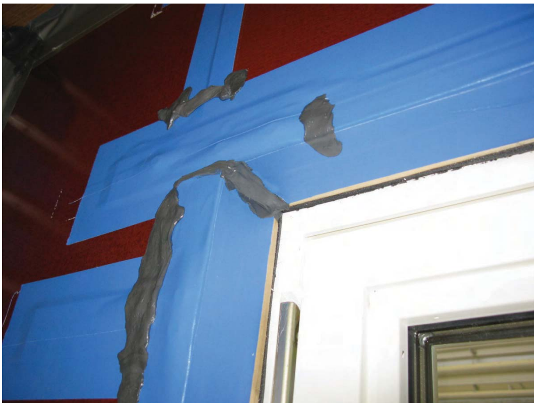
Bild 6: Träreglar mot fogband (med knådplast i hörnet) som motsvarar en konstruktion med puts/fogband.
