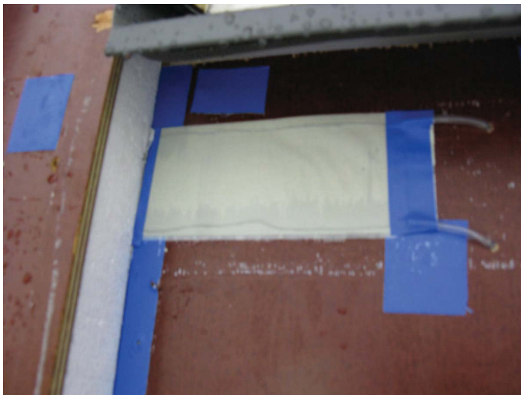
Bild 6: Blöt fuktindikator efter provning
