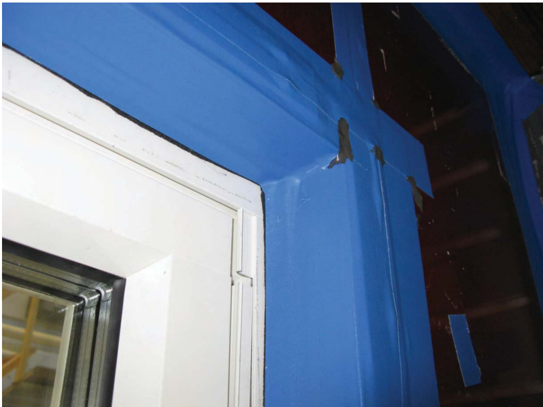
Bild 10: Utsida vägg med tejp och knådplast på anpassade träreglar som representerar tät puts.
