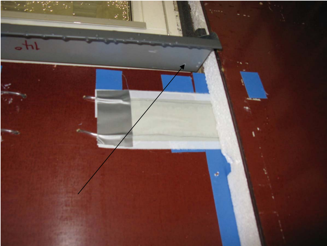
Bild 11: Blöt fuktgivare och väggyta bakom cellplasten efter provningen. Synliga droppar kvar på undersidan av fönsterblecket.
