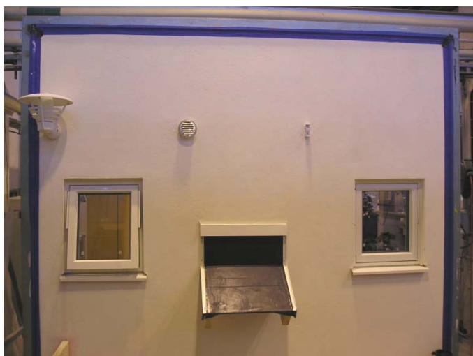
Figur 1 Provvägg 3x3 m regntäthetsprovning med två fönster, ett skärmtak, en lampa, en ventil och en stuprörsinfästning.
