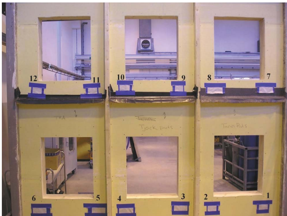
Bild 1a: Utsida vägg. Här är fuktindikatorer 1-12 monterade.
