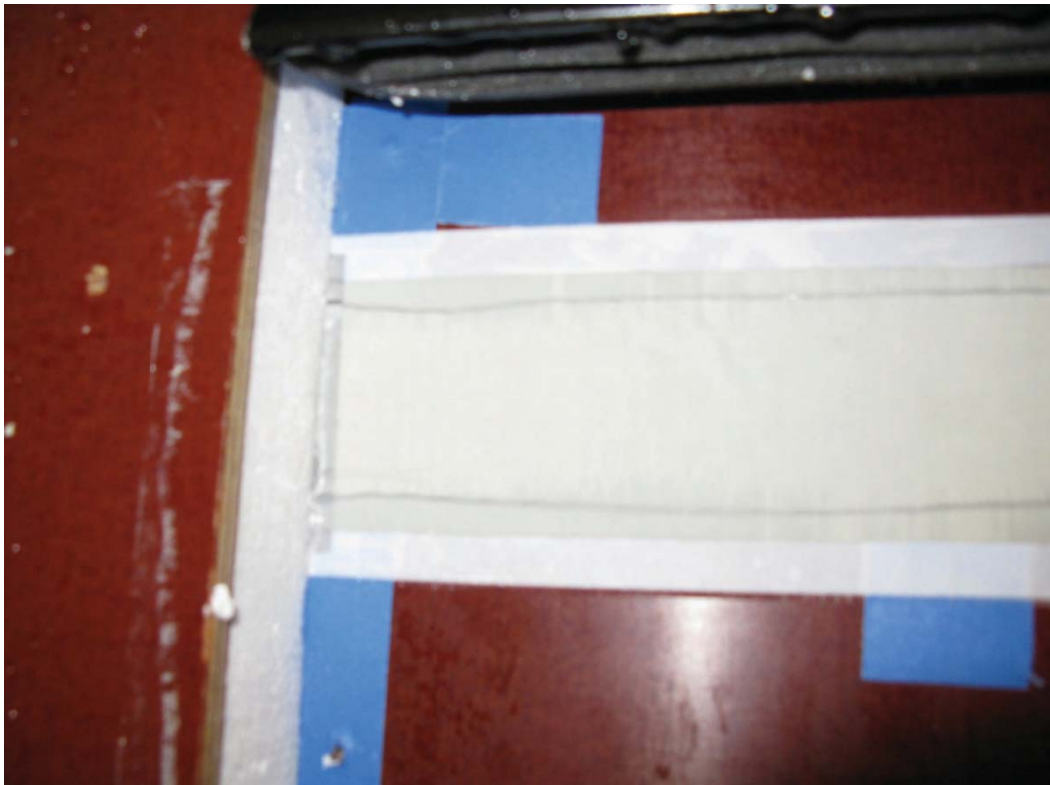
Bild 4: Blöt fuktgivare efter provning
