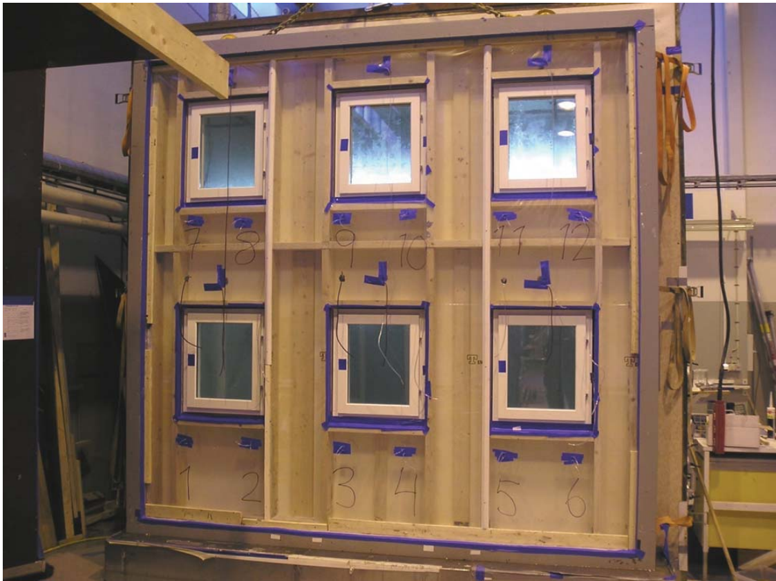
Bild 1b: Insida av fasad monterad i regnkammare, färdig för test.
