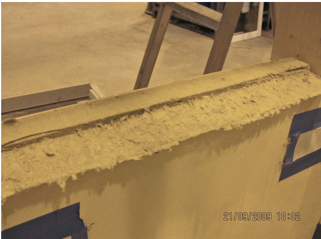
Bild 14: Utsida vägg. Kombinerad kil och rektangulärt upplag i ett stycke av stenull. Den rektangulära delen motsvarar ca halva karmens djup.
