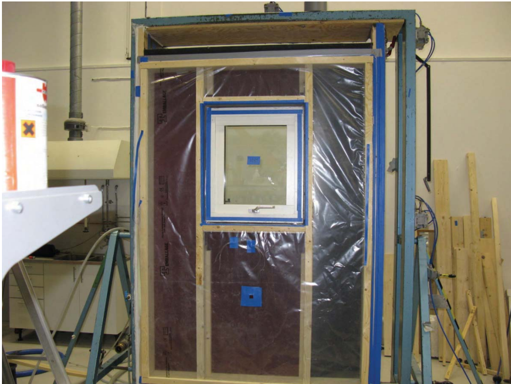
Bild 1: Insidan av provföremålet monterat i provrighen med 0,58 x 0,68 träfönster.
