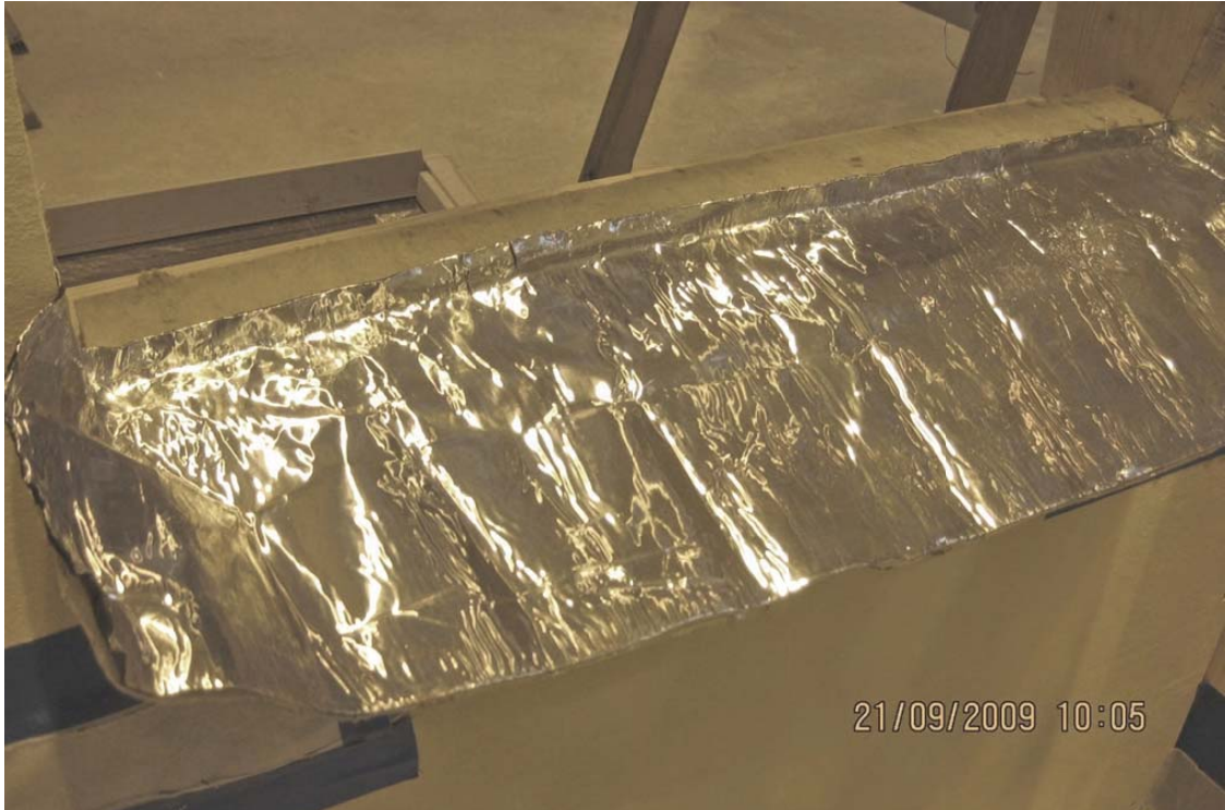
Bild 15: Utsida vägg. Fiberduken "baljan" är klistrad på fronten av stenullen och vidare ut.
