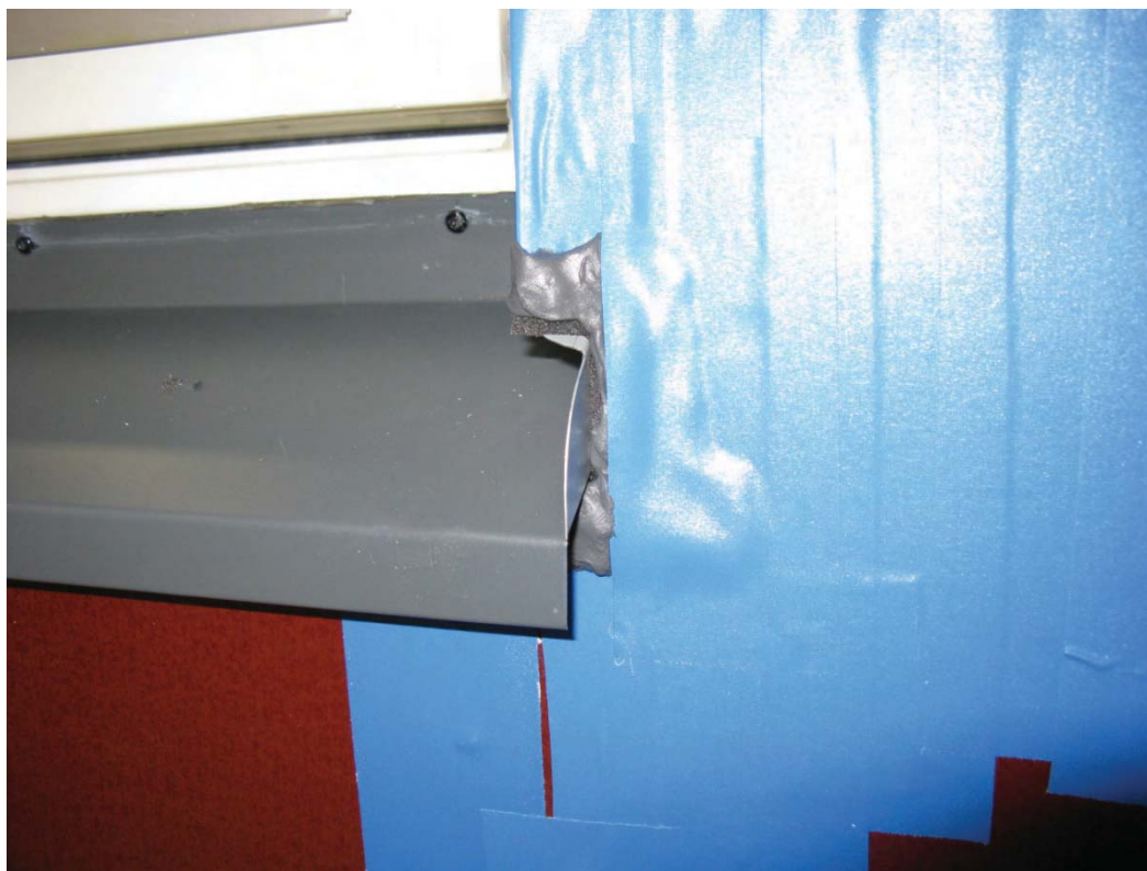
Bild 3: Blå tejp samt svart knådplast, som ska motsvarar tät puts
